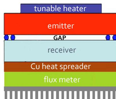
Figure 2.9. Experimental setup (Hu *et al.*, 2008).
