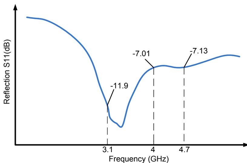
Figure 5.8. LNA input reflection layout simulation.
