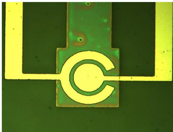
Figure 3.28. Corbino layout transistor( $r_1=15 \mu\text{m}$   $r_2=18 \mu\text{m}$ ).
